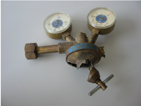
Bilder 3 und 4 ausgebrannte Druckminderer
