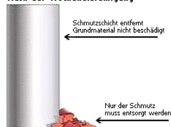
Nach der Trockeneisreinigung
