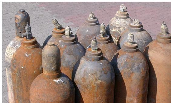
Druckgasflaschen, die einem Brand oder anderweitiger extremer Erwärmung ausgesetzt waren, und die anscheinend unbeschädigt sind, können dennoch eine Gefahr darstellen, wenn sie vor dem Transport bzw. der nächsten Befüllung nicht einer sorgfältigen Überprüfung unterzogen werden. Daher sind folgende Hinweise zu beachten:
